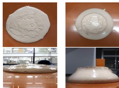
図 5 静置後のバライトの体積割合が異なる超重泥水のフロー形状 (水 100g に対し左 140g, 右 190g)
