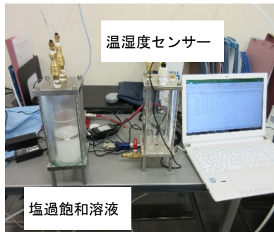
図-1 循環型湿度測定装置
