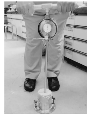
写真-4 コーンペネトロメーター試験
