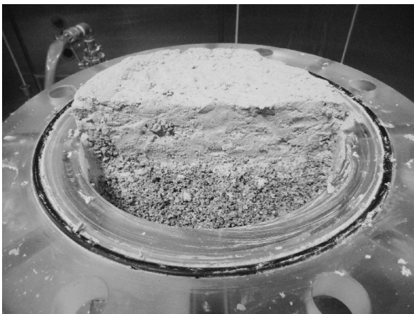
写真-2 模擬地盤上に形成された脱水層
