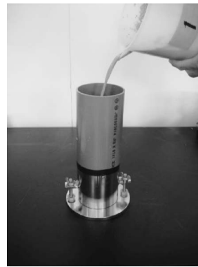
写真-3 沈降層作製状況
